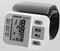
手首式は、計測方法が簡単で価格も安いというメリットがありますが、体の末梢で計測するため外環の影響を受け、他の方式と比べて精度がおちます。血圧計を心臓のあたり(左胸)にあてて測ってください。
