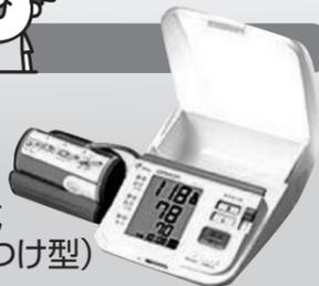
上腕式(巻きつけ型)は、上腕で計測するため手首式よりも正確に計測できますが、腕に巻く作業が面倒です。価格は安いものが多いです。
